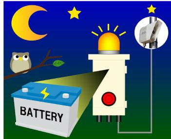
ソーラー電源での悪天候時や夜間、発電機運用にて運転が停止した後は、自動的にバッテリー運転に切り替わり警報の待機を継続します。
