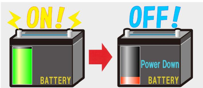
低電圧保護回路は、電圧が低下すると自動的に回路が作動して出力を停止し、バッテリーを保護します。
